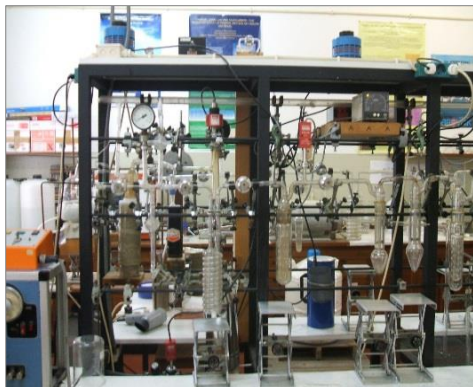
Linha de síntese de benzeno para datação por ^{14}\text{C}
